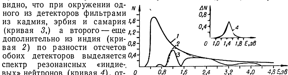
Рис. 4. Спектр зарегистрированных борным детектором нейтронов, пропущенных через различные фильтры:
